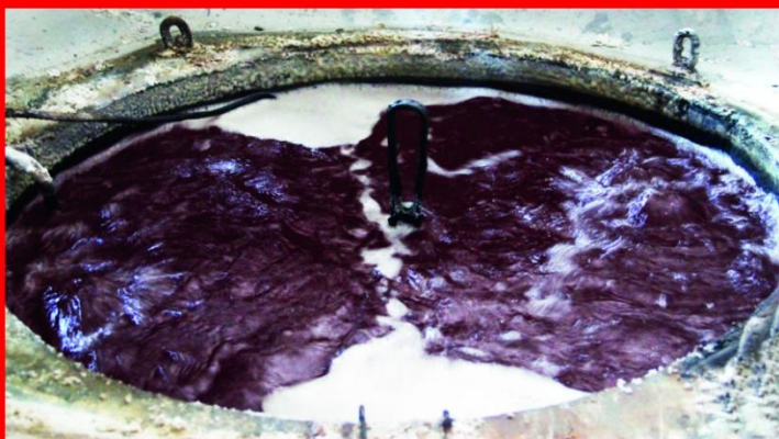
Ванна для карбонитрации, диаметр 950мм, глубина 500мм
