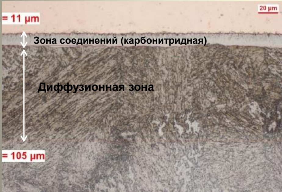
Типовая микроструктура стали после карбонитрации
