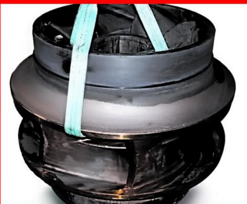
Колесо рабочее. Сталь CA6NM ASTM A352, h=0,12мм, 927HV (63HRC)
